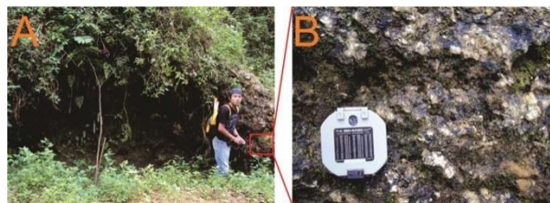
Gambar 19. Singkapan litologi coral wackestone pada satuan batugamping Kalipucang di daerah Watukelir, arah kamera N270°E ( Gambar A ), close up litologi coral wackestone , arah kamera N190°E ( Gambar B ).
