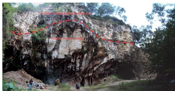
Gambar 6. Kontak singkapan di daerah Pakuran antara satuan breksi Gabon dengan satuan batugamping Kalipucang, arah kamera N284°E.
